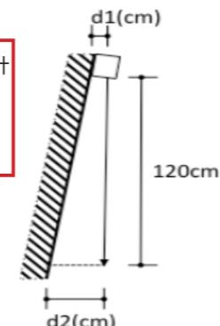
右図のように糸が壁から離れている場合には、その距離(d1)を測った距離(d2)から引きます。
