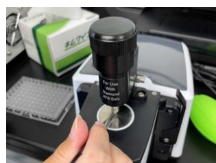
MPの材質をFT-IRで分析する
