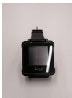
写真2 (左) . 睡眠時の活動量を測定するアクチグラフ
